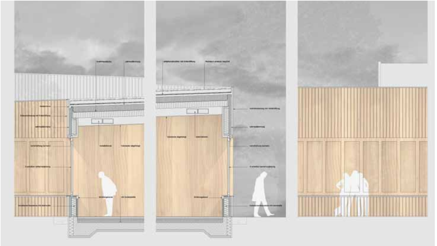
Fassadenschnitte und Detailansichten M 1:100
